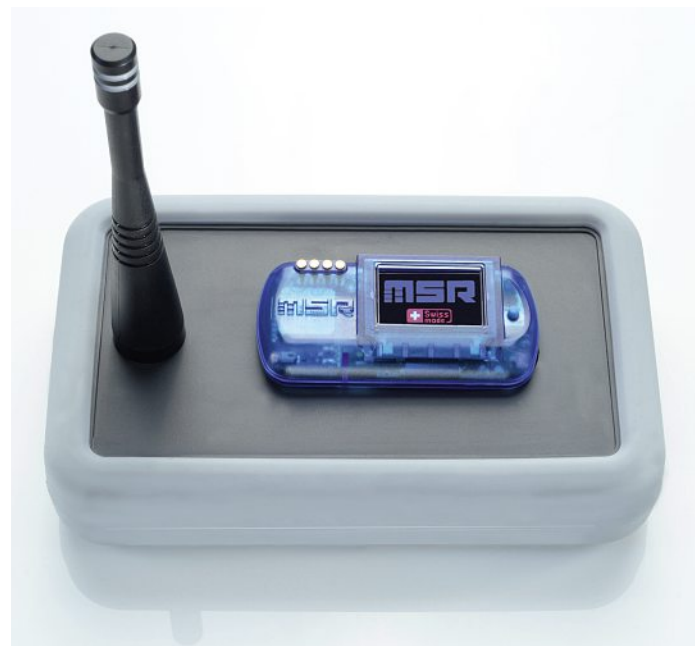
MSR385WD-Funk-Datenlogger empfängt bis zu 10 Sendemodule.
