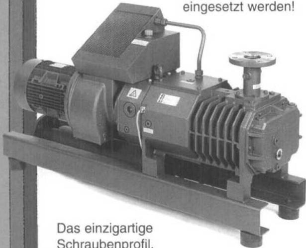
Das einzigartige Schraubenprofil, die spezielle Oberflächenbehandlung und die robuste Bauweise ermöglichen das Fördern von kritischen Gasen und Dämpfen und dies alles ohne jegliche Schmierung! Saugvermögen bis 2500 m<sup>3</sup>/h, Enddruck einstufig < 0,1 mbar.
