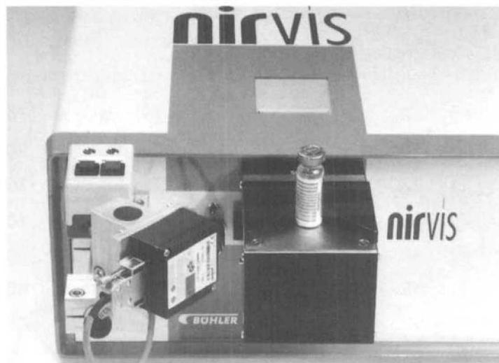
Für die NIR-spektroskopische Analytik von sterilen oder toxischen Materialien in geschlossenen Glasfläschchen hat die Bühler AG einen Proben Tisch entwickelt, der anstelle des Standardlichtleiters über die Lichtleiterschnellkupplung innerhalb von Sekunden am FT-NIR-Spektrometersystem NIRVIS montiert werden kann.
