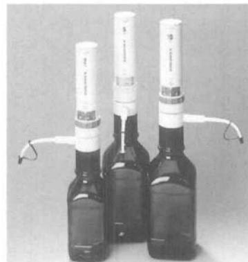
Diese Dispenserlinie beinhaltet drei echt digitale Instrumente, welche einen Flüssigkeitsdosierbereich von 0,25–2 ml, 1–5 ml und 1–10 ml abdecken. Hochwertige Materialien und entwickelte Technologien vereinigen sich in der mechanisch einfachen Konstruktion des Gerätes.
