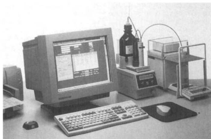
rungen werden so insgesamt zehn Datengruppen ermittelt. Nach Beendigung des Prüfvorgangs kann ein ausführlicher Testreport ausgedruckt werden. Er enthält neben den Arbeitsbedingungen, Messwerten und Rechenresultaten auch eine grafische Darstellung des relativen Fehlers in Abhängigkeit vom dosierten Volumen. Die Beurteilung des Dosiergeräts erfolgt aufgrund der berechneten Werte für die Steigung, den Ordinatenabschnitt sowie den
