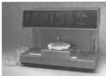
Umwälzend neu von Spiral Biotech, früher Spiral System Instruments, ist der Autoplate 3000. Dieser Spiralplattenapparat der Mikroprozessorgeneration bringt echte Fortschritte beim Ausplattieren von Petrischalen, sei es für die direkte Keimzahlbestimmung oder modifizierte Verfahren wie Konservierungsmitteltest, AMES-Test und MIC's.
