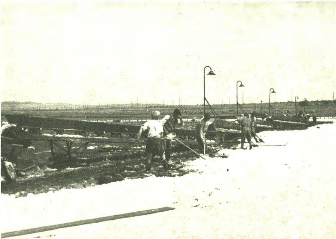
Abb. 2. Salzernte mittels tragbarer Bandstraßen
