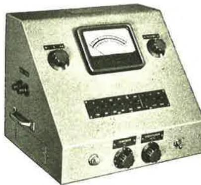
pH- und elektrometrisches Titrations-Meßgerät
