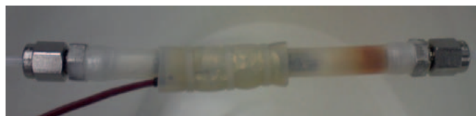
Fig. 1. PTFE tube for the preparation of the organo-magnesium (source: TB2010, Criblage de réactions à l'aide d'un microréacteur, Mr. Roch)
